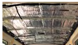
制振・断熱施工
