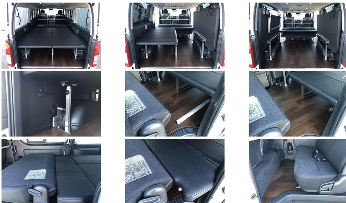
※後席前から後ろまでフロアシートを張り替えています。ロンシール工業株式会社製。「ロンクレオ」を採用。車検対応。バス・特装車等自動車向け PVC 製床上張材。 難燃 JABIA 登録。 防滑 JABIA 登録。バスにも採用されている耐久性に優れた重歩行用 PVC 製床上張材です。
